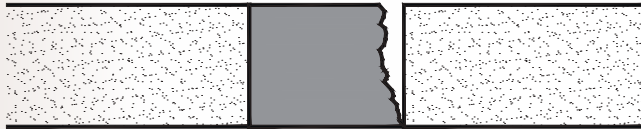
Figura 8.1. Falla adhesiva de sellador.
