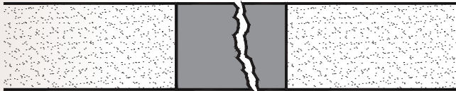
Figura 8.2. Falla cohesiva de sellador.
