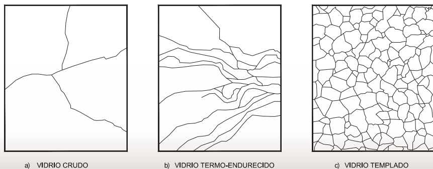
Figura 9.3. Esquemas de fractura de vidrios crudo, termo endurecido y templado.
